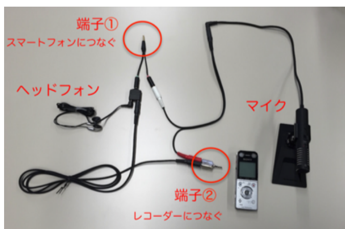
図 1.3: 電話収録時に使用した機材
