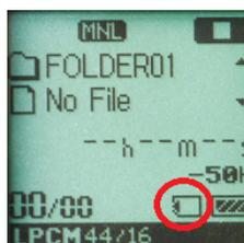
左図のように、電池マークの右側にメモリーカードのマークが出ていることを確認する。
