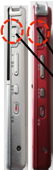
右側面の「電源・ホールド」スイッチを**下方向**に**長め**に動かして電源を切る。
