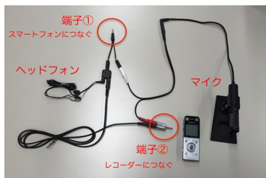
図 3-16 電話収録時に音声分離のために使用していた機材設置例 (現収録では用いず)
