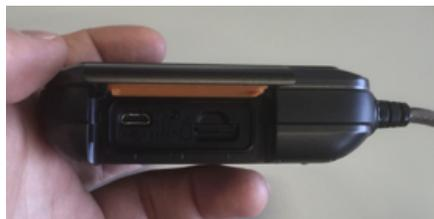
電源と本体を接続すると、電源ボタンの右上のランプが赤く点滅します。充電が完了すると、ランプが消えます。
