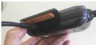
操作部の右側面にあるつまみを「OPEN」側に動かし、操作部の裏側方向に向けてカバーをスライドさせます。カバーがはねあがります。
